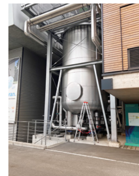
Il bioreattore è il cuore del sistema Power-to-Gas.
