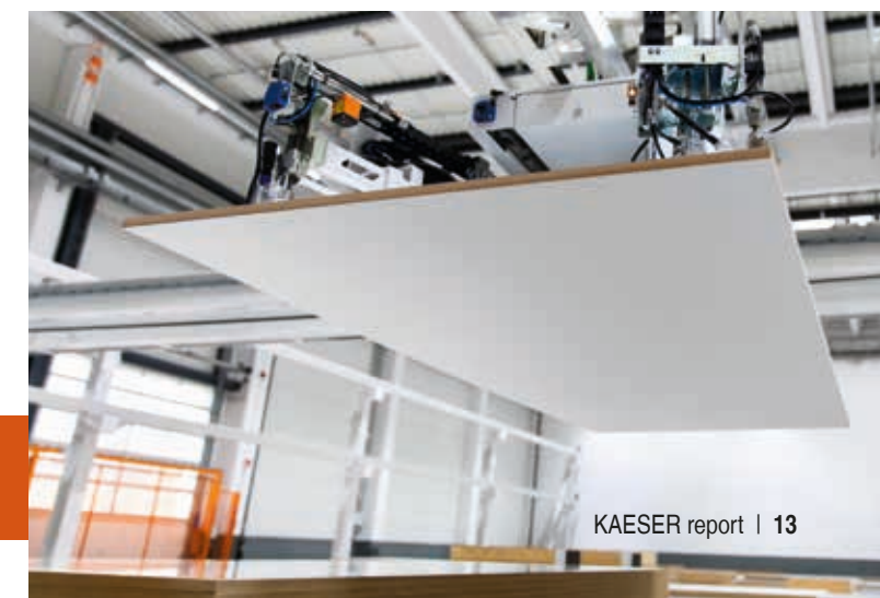
Per gli aspiratori che sollevano pezzi di lavorazione di grandi dimensioni è necessaria l'aria compressa (principio Venturi).
