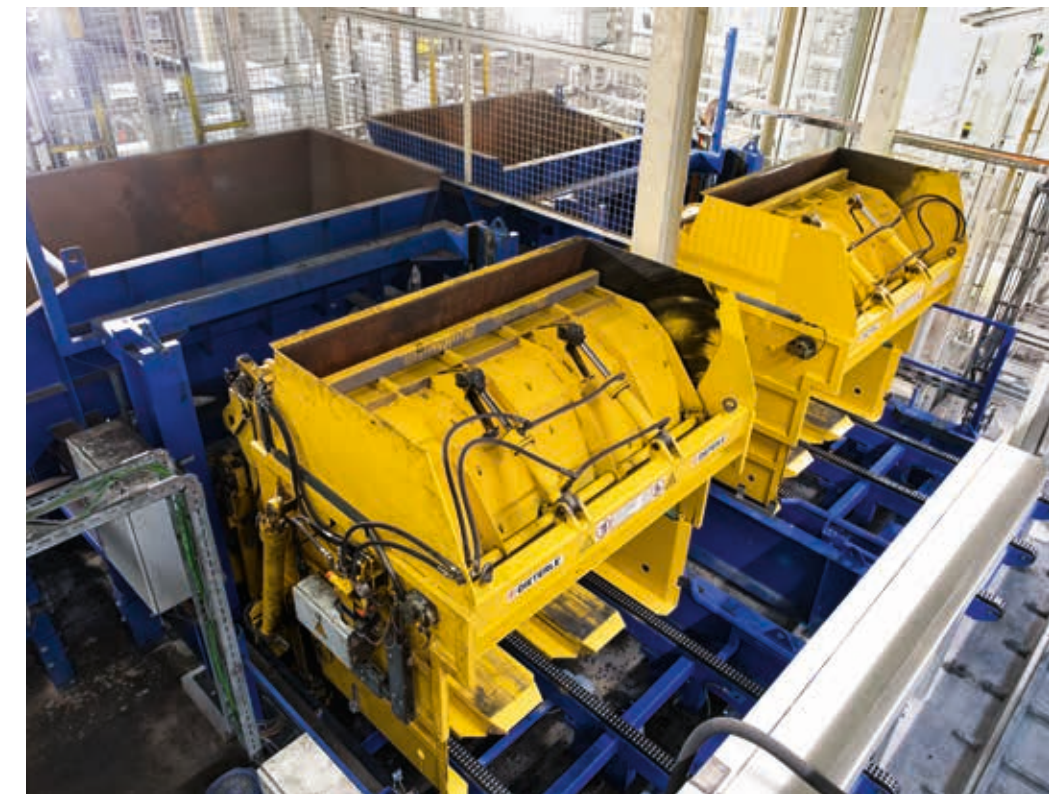
In questi dispositivi di sollevamento e ribaltamento avviene la preparazione o il caricamento per il rivestimento di materiale sfuso (lavorazione a tamburo).
